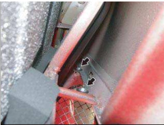
■ 拧紧紧固车门下部饰板(A)后部的两个内部螺母。
