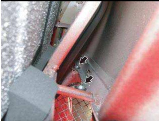
● 松开紧固车门下部饰板**(A)**后部的两个内部螺母。
