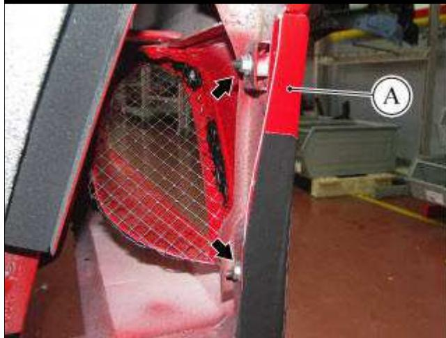
● 松开紧固车门下部饰板**(A)**后部的两个螺母。
