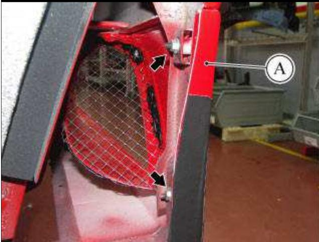
■ 拧紧紧固车门下部饰板(A)后部的两个螺母。
