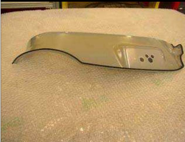
● 当更换或重新油漆密封条盖时, 在重新装配之前有必要在外侧使用外部边缘密封条。
