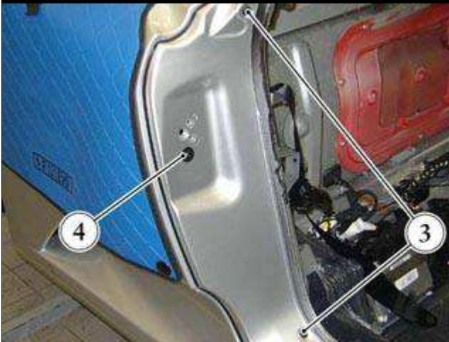
● 松开两个上部和下部紧固螺钉(3)以及中央螺钉(4)。
