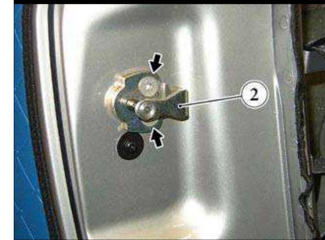
● 松开两个紧固螺钉并拆卸车门撞针托板(2)。
