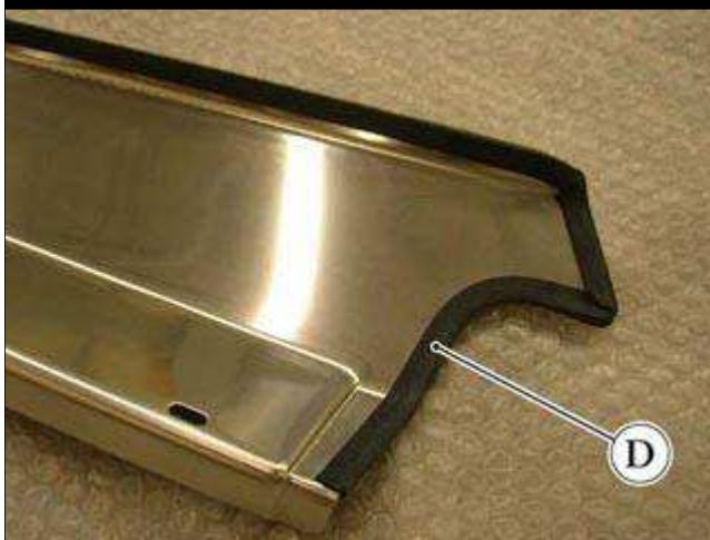
● 当更换踢板时, 沿着新部件的外部和前部边缘安装相关的密封圈(D)。
