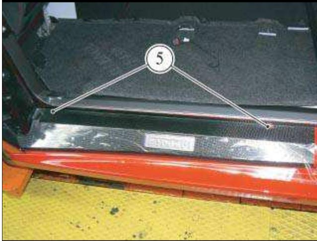
● 拧下将踢板固定到门槛的两个螺钉(5)。
