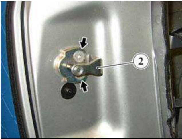
● 暂时紧固车门撞针托板(2)。
