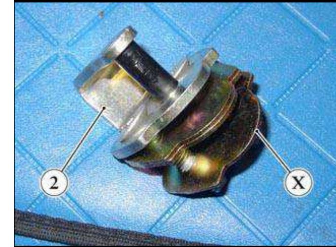
● 拆卸车门撞针托板(2)安装的任何垫片(X)。
